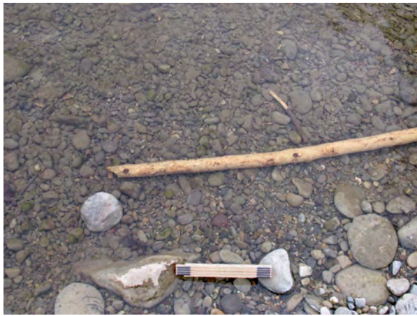
Bild 8.14 Geringmächtige Ablagerungen von Schüttmaterial auf der grobkörnigen Kiesbank im Bereich der Barzmühle (links benetzt, rechts trocken, Aufnahme datum 25.1.2006). Länge des Doppelmeters 24 cm.
